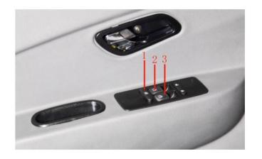
После нажатия аварийного выключателя, переключатель стеклоподъемника передней пассажирской стороны работать не будет, но переключатель управления стеклоподъемником правой двери со стороны водителя будет продолжать работать.
