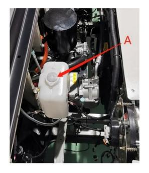
Своевременно восполняйте моющий раствор, если уровень жидкости низкий или она отсутствует. При заливке моющего раствора поверните крышку бака, чтобы открыть ее для заливки моющего раствора А. Не используйте жидкость, содержащую спирт.
