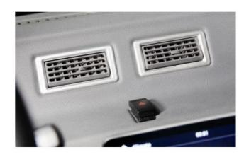
Если нажать выключатель лампы аварийной сигнализации, то все индикаторы и указатели поворота будут мигать. Индикаторы указателей поворота на комбинации приборов панели будут одновременно мигать. Все индикаторы и указатели поворота перестанут мигать, если снова нажать выключатель лампы аварийной сигнализации.
