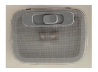
Если переключатель находится в центральнос положении, то внутренняя лампа загорится, при открытии или неплотном закрытии дверей. Водитель может устанавливать кнопку освещения в различные положения. При этом, внутренняя лампа будет гореть, чтобы напомнить пользователю, когда дверь открыта или не закрыта.
