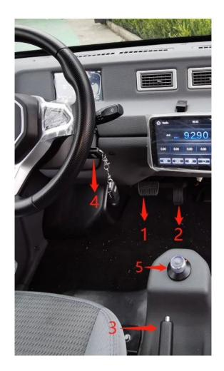
Парковка: Потяните ручной тормоз 3 вверх, до упора или характерного звука. В результате ручной тормоз 3 будет зафиксирован в текущем положении, и автомобиль будет припаркован.
